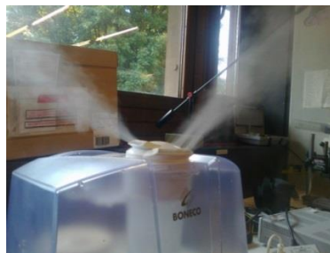
Figure 2 : Humidificateur à ultrasons
