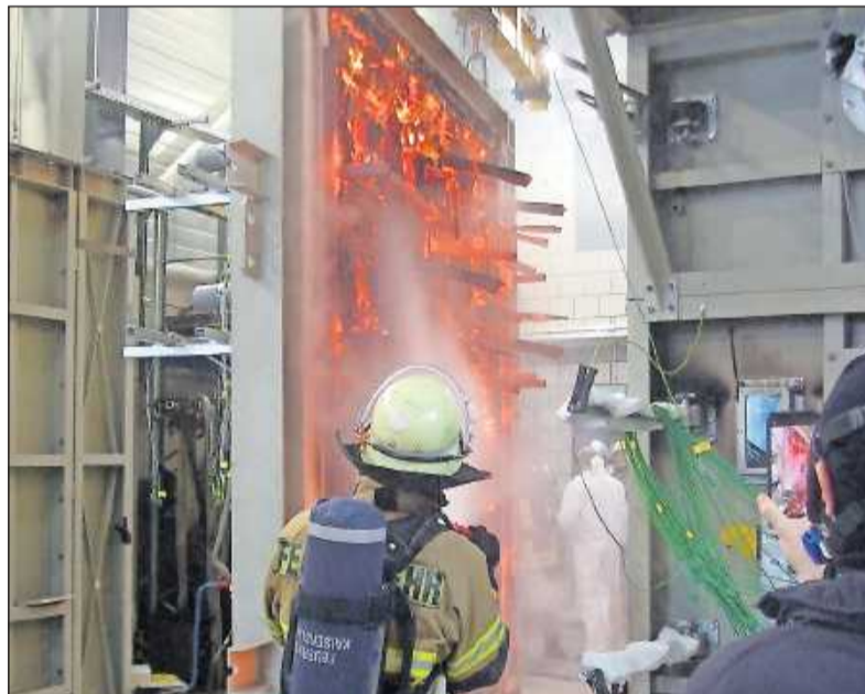
Das ist die brennende Rückseite der Holzwand nach dem Versuch. Die Feuerwehr löscht.
