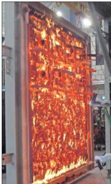
Die brennende Holzwand wird vom Brandofen weggeführt.
