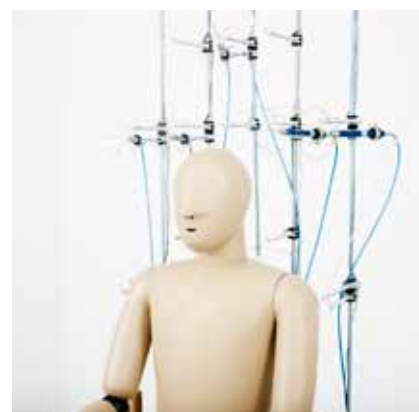
Abb. 9: Thermisches Manikin »Feelix« im Prüflabor zur Untersuchung des Raumklimas
