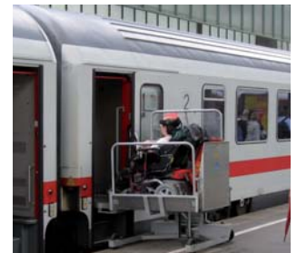
Klassischer Hublift, wie er derzeit auf vielen Bahnhöfen im Einsatz ist.
