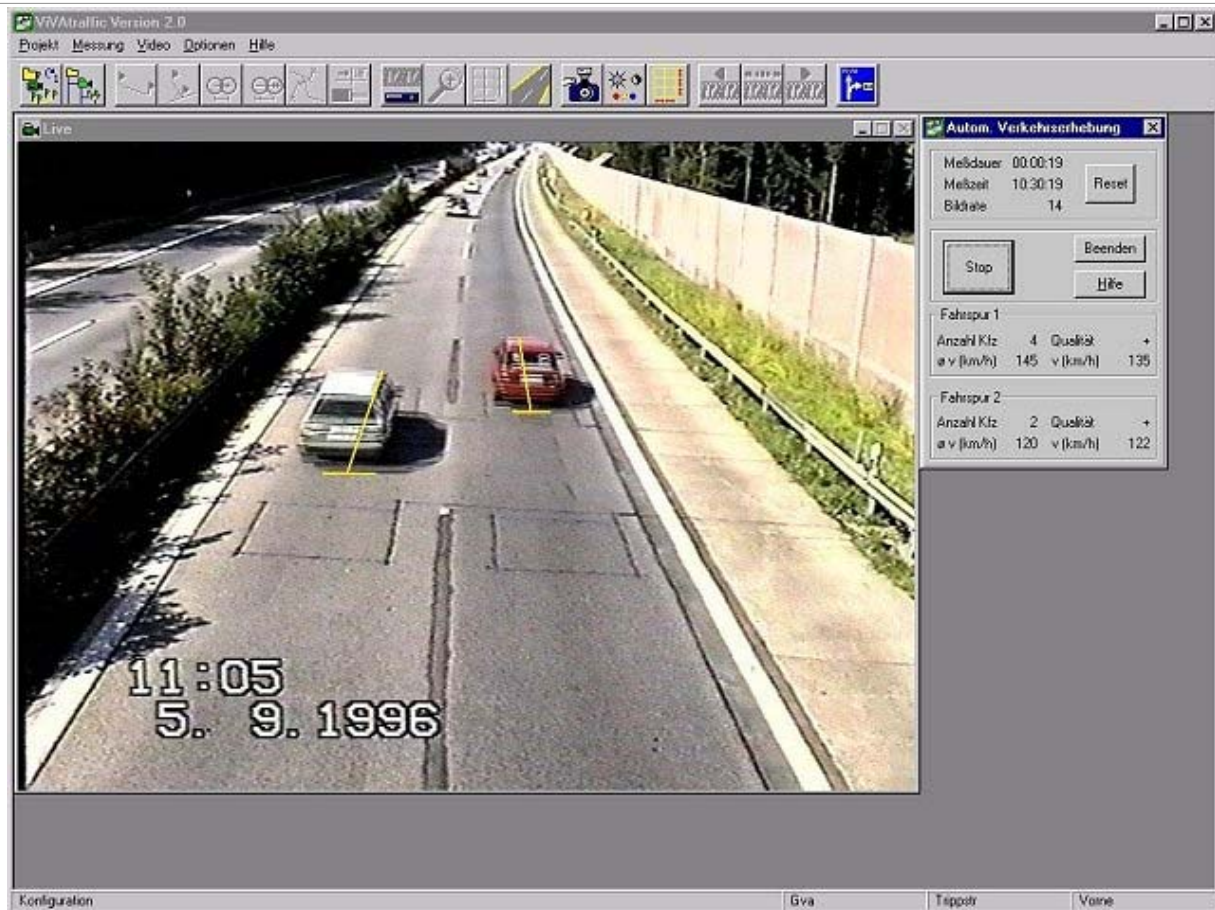
Abbildung 6 - Automatische Verkehrserhebung in ViVAtraffic auf einer Autobahn. Im Dialog werden die aktuellen Geschwindigkeiten der beiden PKWs angezeigt. Im Bild sind die detektierten Fahrzeug-Hinterkanten und Fahrzeuglängen markiert.
